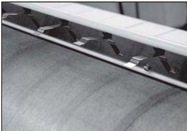
При необходимости очистки пружин или гладильного полотна следует дополнительно обмотать вал или в течение некоторого времени гладить без устройства приема белья так, чтобы оно поднялось. При наличии **устройства возврата белья** его следует перевести в сервисное положение.
