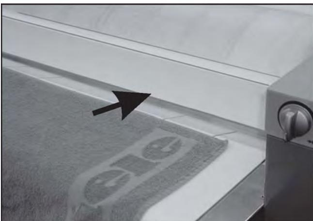
При попадании пальцев между столом подачи белья и планкой защиты пальцев гладильный вал сразу останавливается, а муфта опускается вниз. В режиме обратного хода планка защиты пальцев не функционирует.
