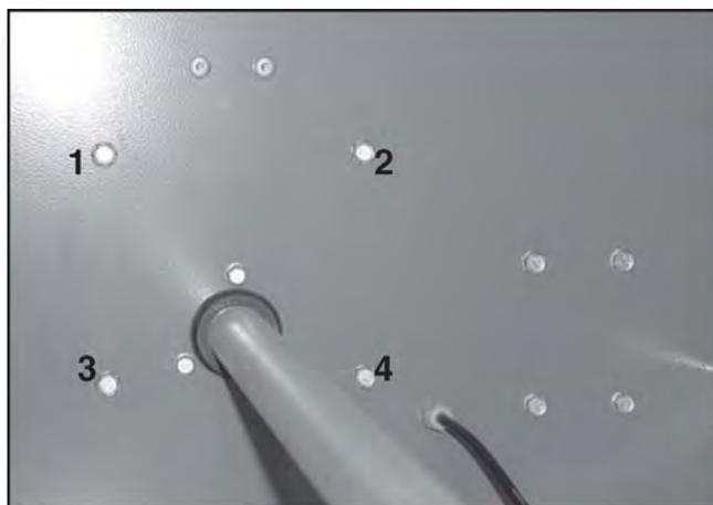
Ослабить все 4 винта на внутренней стороне правой боковой стойки, чтобы корпус механизма освободить от боковой стойки. Затем опять затянуть эти 4 винта.
