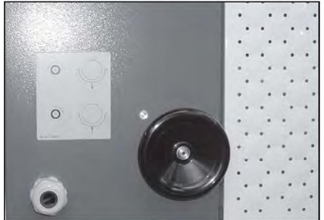
Для того, чтобы при нарушении электропитания можно было отделить горячую муфту от остановившегося гладильного вала: при вращении против часовой стрелки муфта опускается, при вращении по часовой стрелке муфта поднимается.
